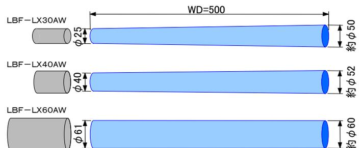
通常の光源は距離の二乗に反比例して光は減衰します。例えば距離が2倍になると光量は1/4 になり遠くを明るく照射することができません。しかし、LBFは疑似平行光なのでこの公式にはあてはまらず距離が伸びても光の減衰を抑えて遠くまで照射可能です。
